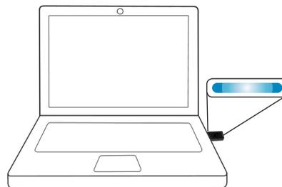
6. uDirect 2 stellt jetzt automatisch eine Verbindung zu Ihrem Computer her, wenn das Gerät eingeschaltet ist, der USB-Adapter im USB-Anschluss steckt und der Computer sich in Reichweite Ihres uDirect 2 befindet
