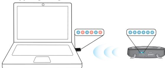
\*Hinweis: Erfolgt die Kopplung des BTD 500 USB nicht automatisch und das Gerät blinkt nach dem Einstecken blau/rot, müssen Sie den BTD 500 USB vom Computer abziehen, dann 2 Sekunden lang wieder einstecken, erneut abziehen und wieder einstecken.
