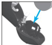
Batterielade weist. Dadurch ist die Batterie nach dem Schließen der Batterielade gegen unbeabsichtigtes Entnehmen gesichert.
