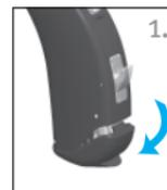
2. Entnehmen Sie die Batterie aus dem Batteriefach.
